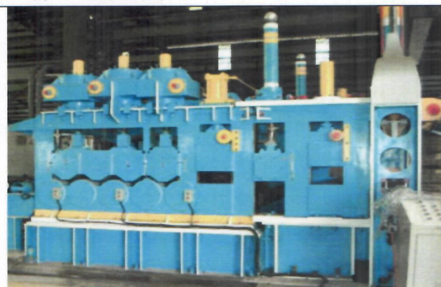
5. 四段整平機組(為整平後方切長)
