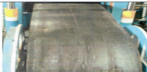
8. 解捲之鋼帶表面概況-銹皮鬆脫嚴重
