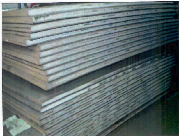
10. 剪切板寬度方向略有下C現象-6096mm (委請大寮-賢源切板)
